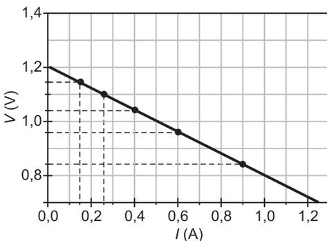
c) Substituindo os valores de  $i_1$  e  $i_2$  na equação de um gerador real ( $V = \varepsilon - ri$ ), temos:
