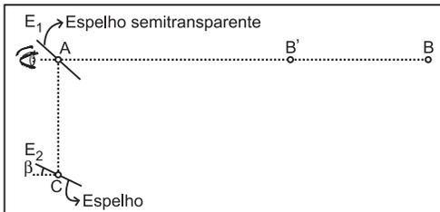
Com o objeto em um ponto B específico, o ângulo  $\beta$  foi ajustado em  $44^\circ$ , para que os raios cheguem ao olho do observador paralelos e superpostos. Nessa condição,
