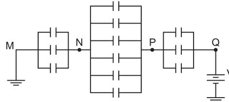
Adotando a capacitância de cada capacitor como  $C$ , e sabendo que na associação em série o capacitor de maior capacitância tem a menor tensão em seus terminais, vem:
